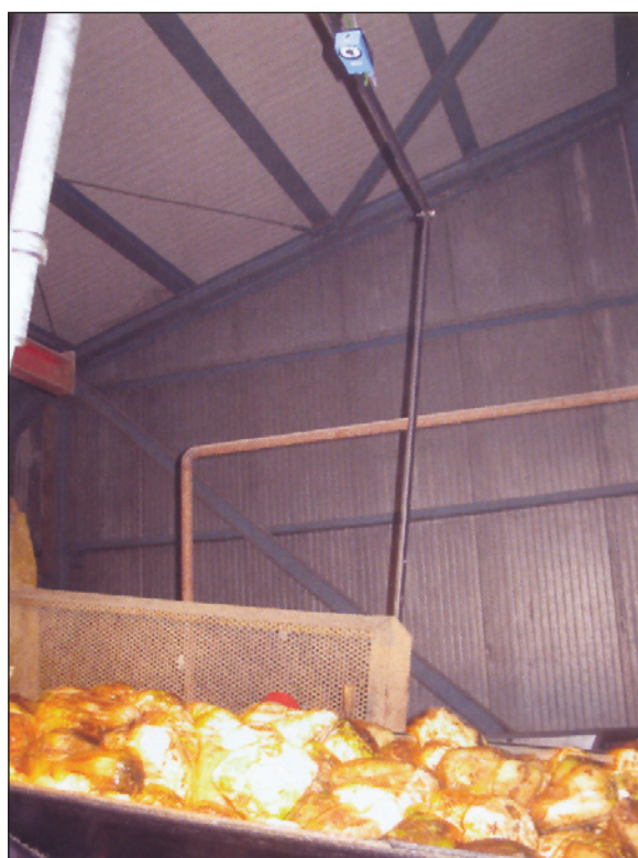
شکل ۹: سنسور Image analyzis نصب شده روی نوار نقاله چغندر
