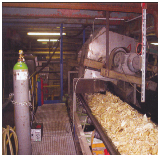
شکل ۱۱: سنسور FID نصب شده روی نوار خلال چغندر
